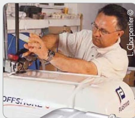
Rettungsinseln werden gebrauchsfertig geliefert. Das Kunststoff-Strapping, das um den Container befestigt ist, darf nicht entfernt werden und reißt bei der Rettungsinselzündung von alleine auf.
